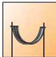
1. Смонтировать нижнюю половину хомута на шпильку.
