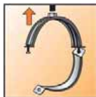
1. Навинтить хомут на шпильку и открыть его.
